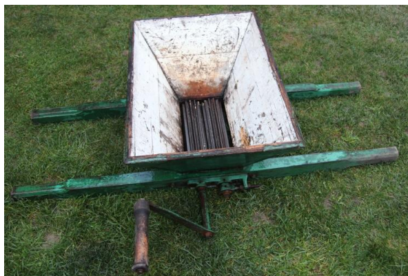
Obr. 4: Dřevěný mlýnek s kovovými válci
